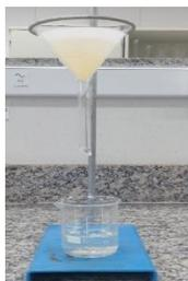
**Figura 4.** Processo de filtração da água barrenta com papel de filtro Unifil, C42 faixa azul.
