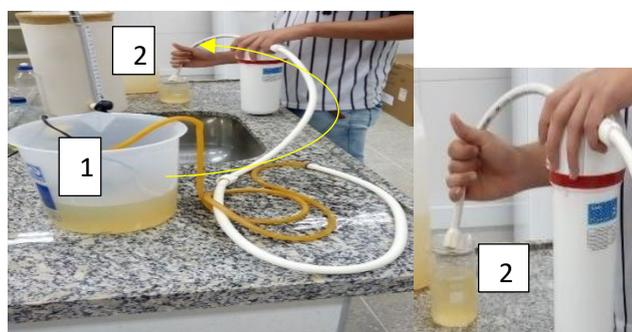
**Figura 3.** Sistema em fluxo com filtro comercial (marca Durin) em uso. (1) Água barrenta antes de passar pelo sistema. (2) Água barrenta após passar pelo sistema.
